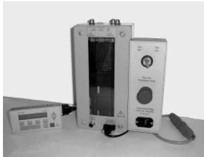
Die vorkonfektionierte Steuerungseinrichtung mit SIMATIC S7-200 und Textdisplay TD 200.
